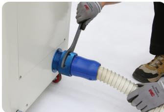
3. (분리 시) 실내기 및 실외기 커넥터에 연결된 후렉시블 커넥션 호스를 동봉 된 라쳇을 이용하여 분리합니다. 이때 커넥터 너트를 반시계 방향으로 돌려서 완전히 분리합니다.
